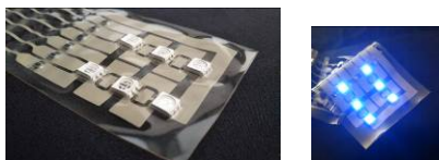
第9図 開発フィルムを用いた試作事例（LEDデバイス）
