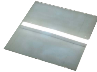
第8図 インクジェット塗布装置で作製したPvk光吸収層 (基板サイズ=300 mm×300 mm)
