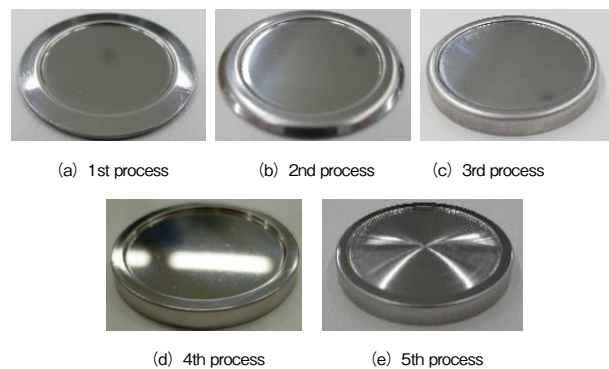
第6図 本開発工法における工程サンプル Fig. 6 Samples in process of our development method
