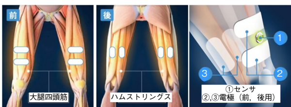
第2図 電極およびモーションセンサ位置 Fig. 2 Position of the electrode pads and motion sensor
