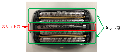
第7図 刃の呼称と配置 Fig. 7 Name and placement of the blade
