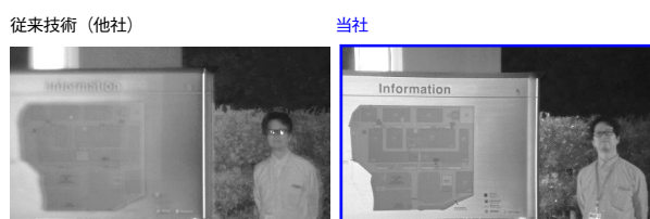
第5図 可視光／赤外光の混合光下での他社比較 Fig. 5 Image comparison with a competitor under mixed visible/infrared light
