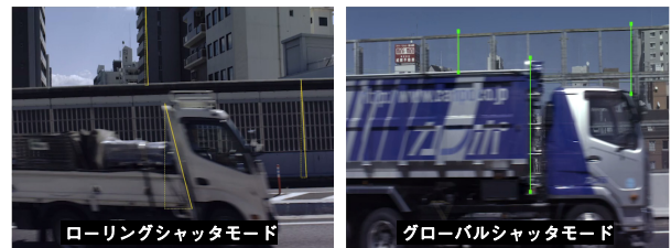
第5図 高速物体:高速道路の対向車線 撮像例 Fig. 5 Image of a high-speed object at an oncoming lane of highway
