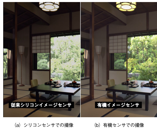
第3図 明暗差のあるシーンでの撮像比較 Fig. 3 Comparison of imaging in a high-contrast scene
