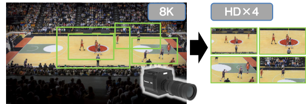
第7図 切り出し処理 Fig. 7 Cropping method
