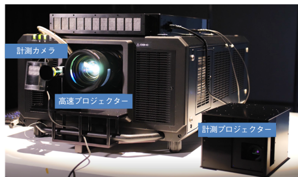
第5図 高速追従マッピングの構成要素
