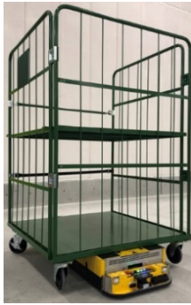
第1図 カゴ車を把持した自動搬送ロボット Fig. 1 Automatic transfer robot holding a basket cart
