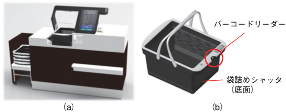
第4図 レジロボ外観 (a) とスマートバスケット (b) Fig. 4 Exterior of (a) Regi-robot and (b) smart basket
