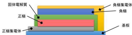
第4図 全固体薄膜電池の概略図
