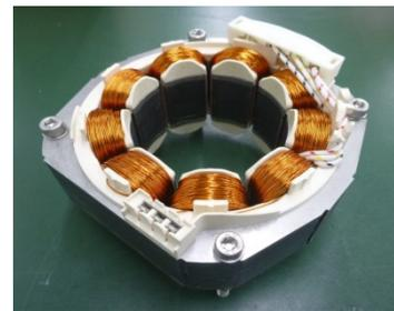
第9図 製作したステータの外観写真
