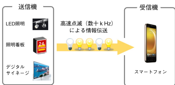
第1図 イメージセンサ受信型可視光通信システム Fig. 1 Image sensor-based visible light communication system
