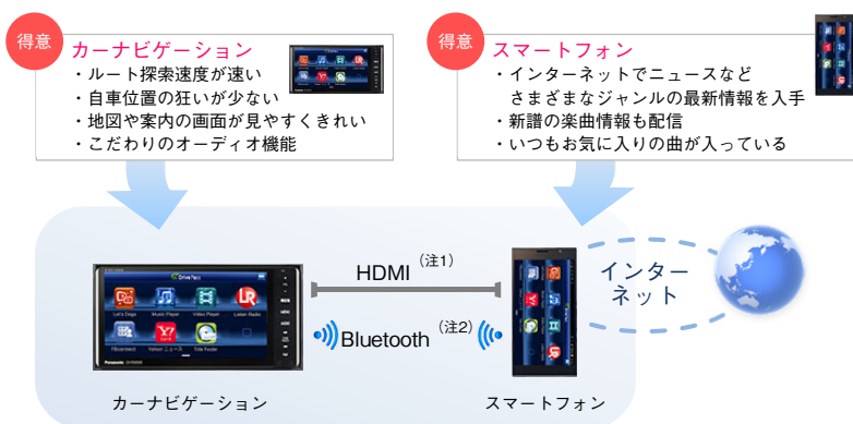
第1図 車載機器とスマートフォンの連携イメージ
