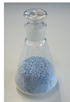
第11図 気体吸着材開発品の外観 Fig. 11 Outside of gas absorbent
