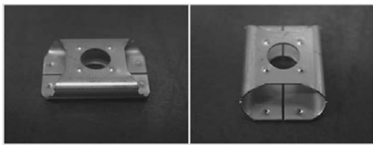
第3図 集電リード構造の概観 (左：側面からの概観，右：縦面からの概観)
