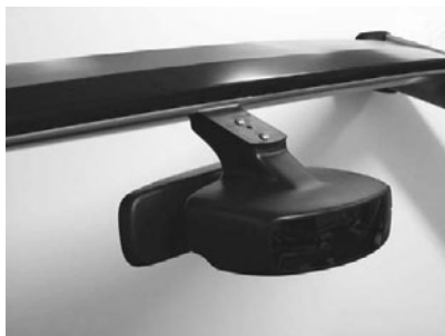
第1図 ルームミラーに内蔵した場合のステレオカメラのイメージ図
