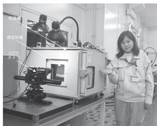
第3図 三次元熱変形計測システム外観図 Fig. 3 External view of three dimensional measuring system for thermal deformation
