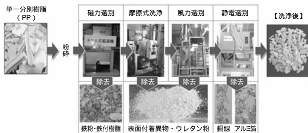
第3図 洗浄のシステムフロー
