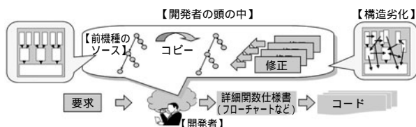
第1図 コード中心開発（流用開発） Fig. 1 Code centric development (Clone & own development)
