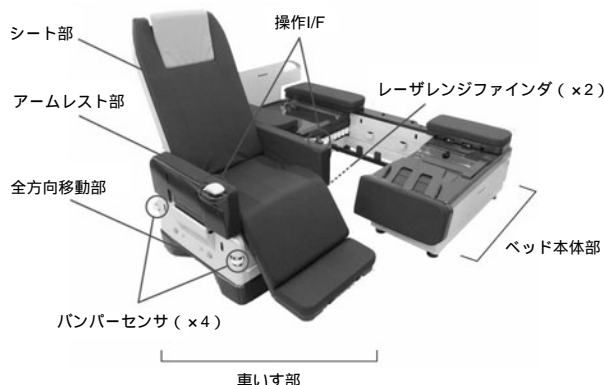
第1図 ロボティックベッドの構成
