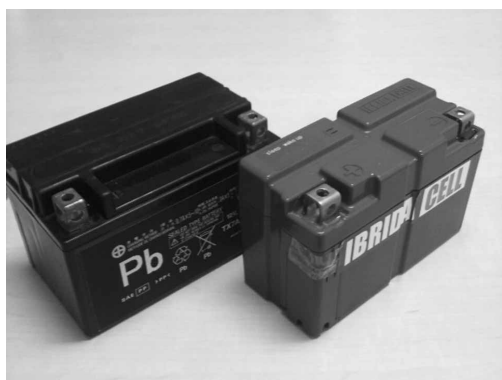
第8図 市販レース向け回路搭載品の試作機（右）と従来の鉛バッテリー（左）
