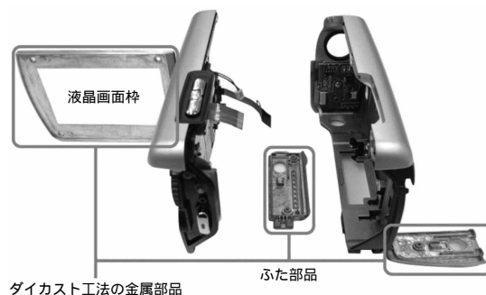
第3図 扉と液晶部筐体の補強 Fig. 3 Strengthening of lids and LCD's cabinet
